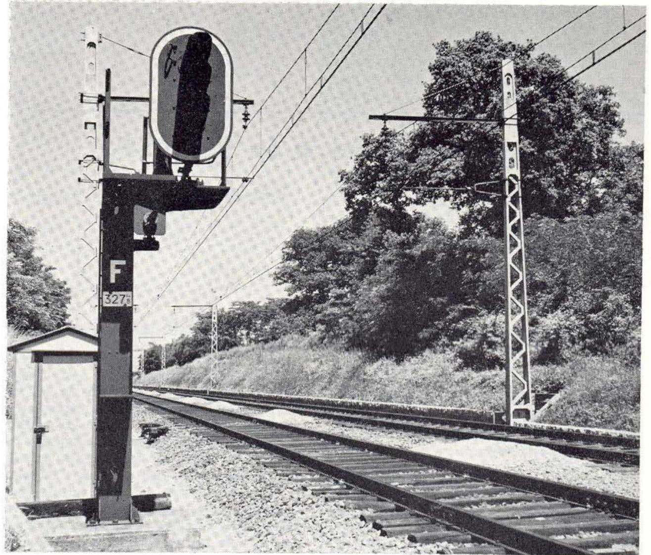
Signal de block de pleine voie du type unifié. La plaque " F " commande au mécanicien de se comporter comme en présence d'un sémaphore fermé, lorsque le panneau affiche le feu rouge et que l'œillette est éteint. ( F = franchissable ).
