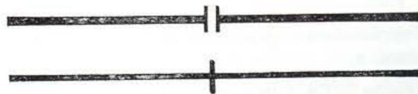
Exemple de prise de courant sur une section de rail. Le fil de câblage, rigide, pointé sous la table, doit aboutir à une cosse relais reliée elle-même au rail par un court fil souple traversant la table. On obtient ainsi un montage discret et robuste (le fil souple peut être d'une section inférieure à celle du câble rigide, et sa présence évite la destruction des soudures par les vibrations ou déplacements éventuels du rail).
