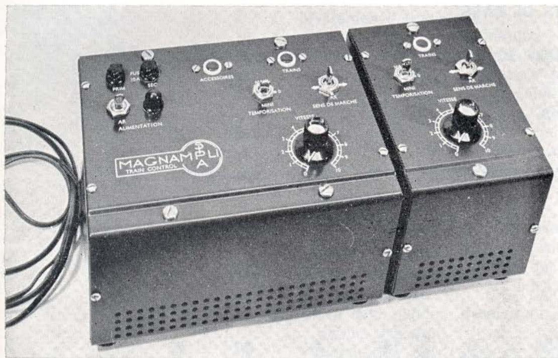
Bloc de commande Magnampli de la SIPA à action temporisée. A gauche le boîtier principal comportant l'alimentation, à droite boîtier annexe alimenté par le premier et permettant le contrôle d'un second train.
